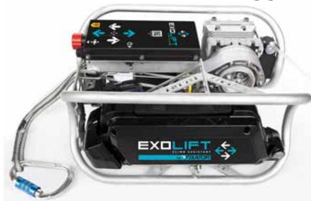
Exolift es un sistema portátil motorizado que permite a un técnico realizar operaciones de mantenimiento en el interior de un generador eólico. Asiste durante la subida y bajada en una escalera de gran altura, limitando sus esfuerzos físicos y cardíacos.
